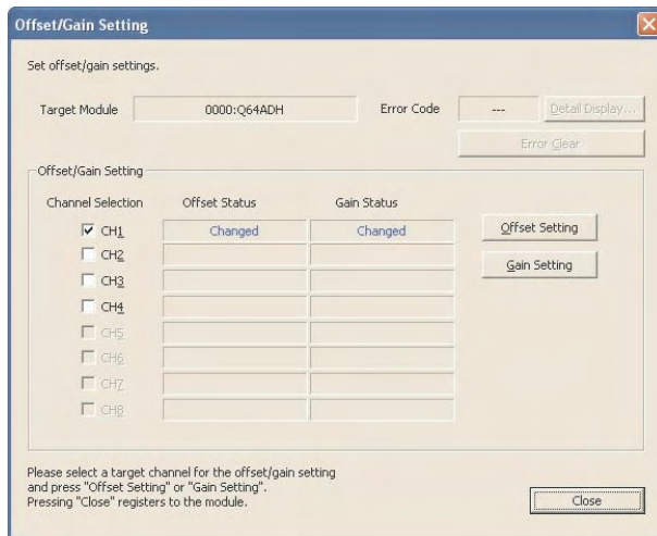
Abb. 7-39: Prüfen Sie, ob als Status für die Verstärkung „Geändert“ angezeigt wird. Klicken Sie dann auf Schließen .
